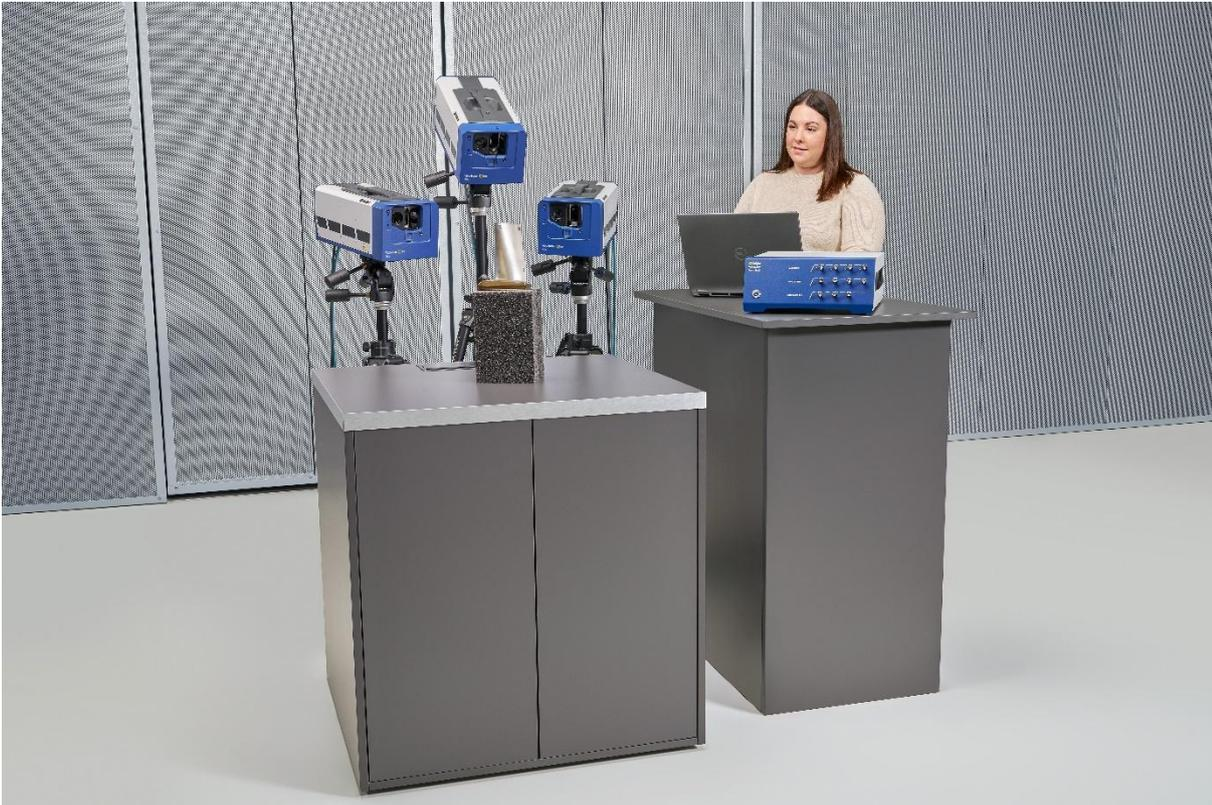
**Caption: Aus 3 mach 1: VibroScan QTec in der 3D-Konfiguration ermöglicht synchronisierte Triax-Schwingungsmessungen für Modalanalyse, Dehnungsmessung und NDT**
