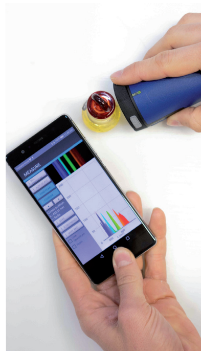
Figure 8 : Exemple d'utilisation du spectromètre IndiGo
